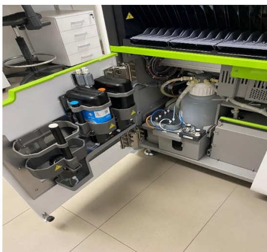
Slika 26. Mjesto potrošnog materijala u aparatu
