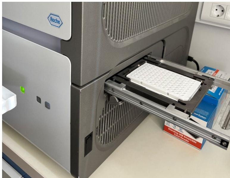
**Slika 32.** Umetanje mikrotitarske pločice u Cobas z480 analizator
