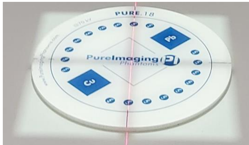
Slika 35 Otvaranje svjetlosnog polja na veličinu fantoma
