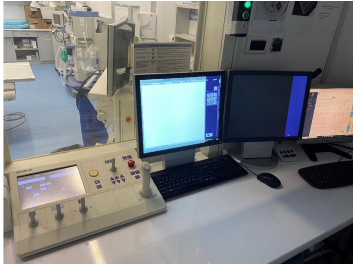
Slika 1 Kontrolna ploča RTG uređaja Siemens Luminos
