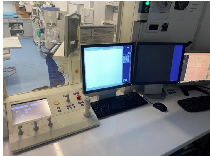
Slika 1 Kontrolna ploča RTG uređaja Siemens Luminos
