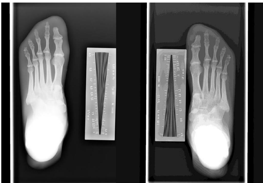
Slika 25 Fokalna točka od 1.2 mm naprma 0.6 mm
