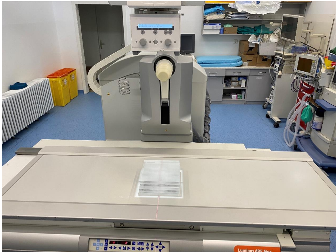
Slika 30 Radiografski uređaj u KBC Osijek Siemens Luminos DRF Max i fantom na uređaju.
