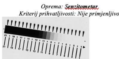
Slika 3 Primjer razvijenog filma osvijetljenog senzitometrom
