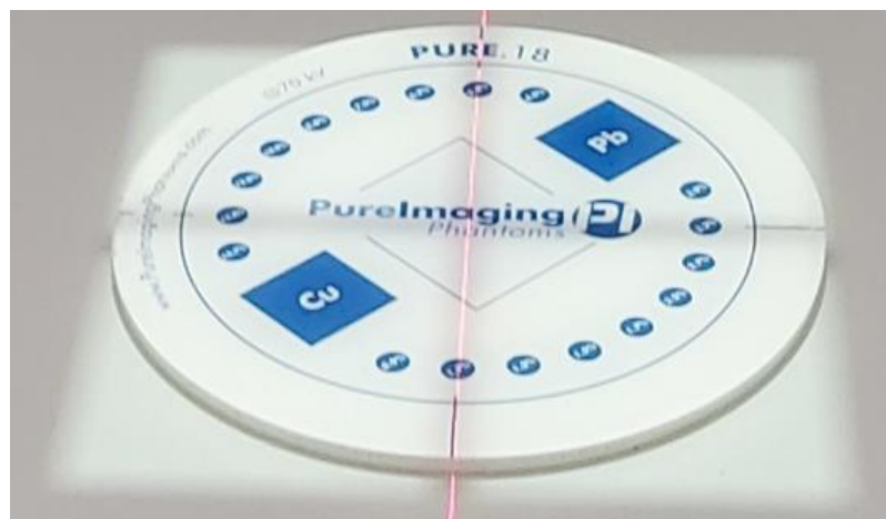
Slika 35 Otvaranje svjetlosnog polja na veličinu fantoma
