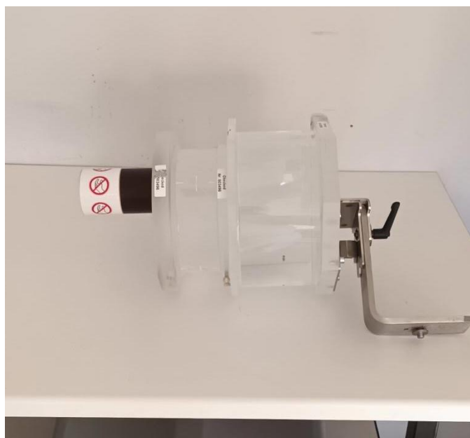
Slika 31. Fantom za uređaj SOMATOM Definition AS+
