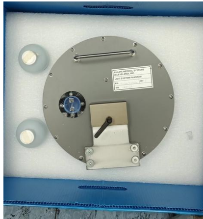
Slika 24. Fantom uređaja Phillips Ingenuity Elite Izvor: fotografija autora iz prostora KBC Osijek
