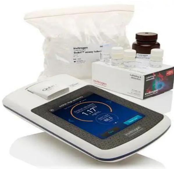
Slika 10. Qubit 4.0 Fluorometer i komplet za analizu
