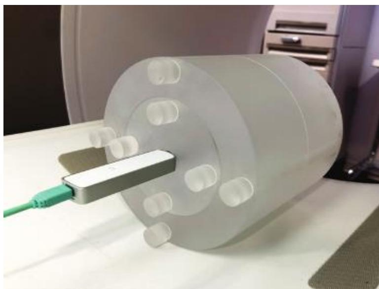
Slika 3. Prikaz akrilnog cilindričnog fantoma veličine 16 cm s ionizacijskom komorom oblika olovke u središnjem otvoru za mjerjenje CTDI100.
