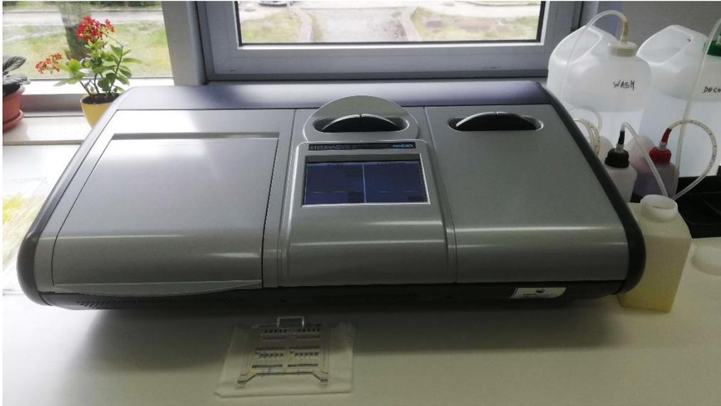
Slika 12. Analizator Hydrasis 2 Scan Focusing proizvođača Sebia.
