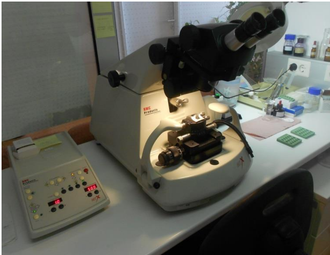
Slika 18. Ultramikrotom na Zavodu za histologiju i anatomiju Medicinskog fakulteta u Splitu
