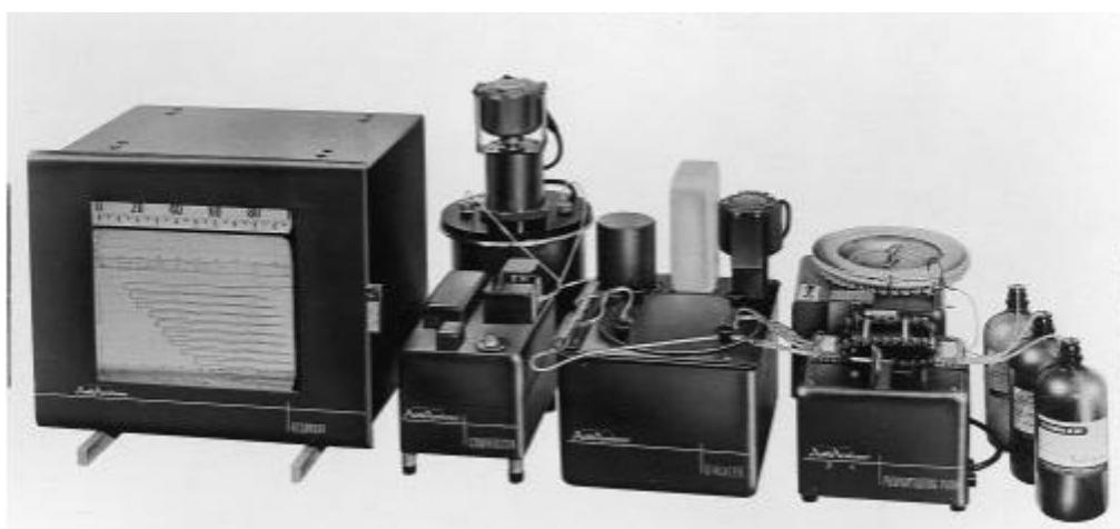
Slika 1. Prvi protočni analizator
