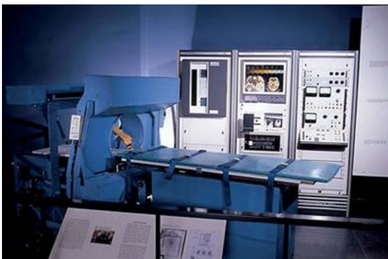
Slika 7. Prvi CT uređaj za snimanje cijelog tijela
