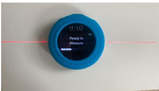
Slika 6. Digitalni goniometar (Halo digital goniometer) – uređaj za provođenje mjerenja opsega pokreta u zglobu
