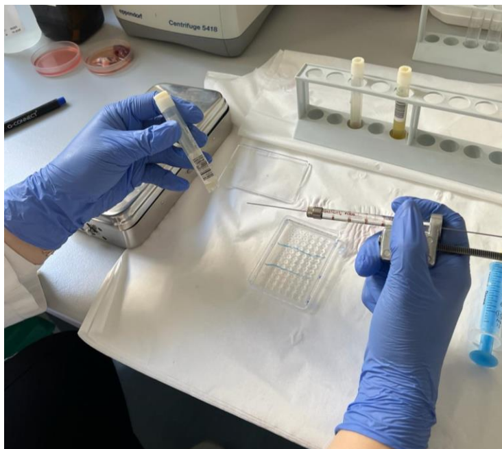
Slika 19. Prikaz postavljanja seruma 4 kandidata za transplantaciju bubrega na Terasakijeve pločice
