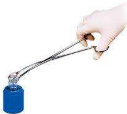
Slika 12. Pinceta za nošenje bočica
