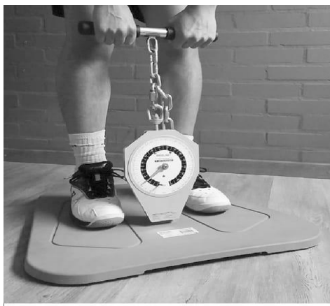
Slika 13. Prikaz fiksnog dinamometra
