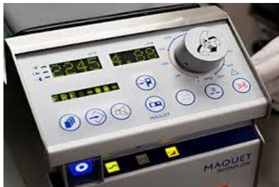
Slika 4. Kontrolna konzola ECMO uređaja (Izvor – osobni )
