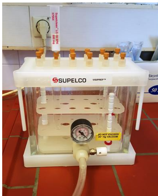
Slika 4. Uređaj za ekstrakciju čvrstom fazom sa SPE kolonom za ekstrakciju
