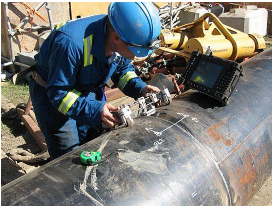
Slika 1. Kontrola kvalitete zavarivanja cjevovoda ultrazvučnim postupkom; Izvor (21)
