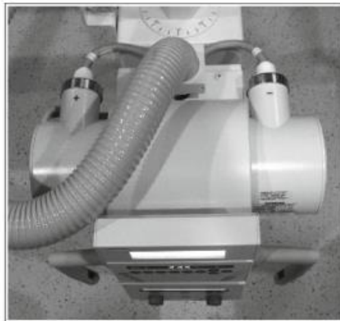
Slika 4. Rendgenska cijeva sa simbolima + za anodu i - za katodu. (Izvor: Web)
