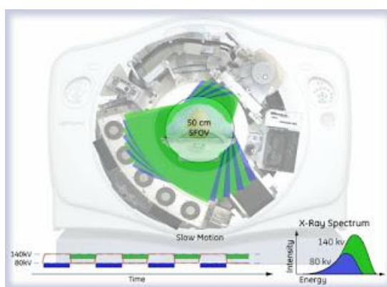
Slika 4. Presjek kroz kućište CT uređaja
