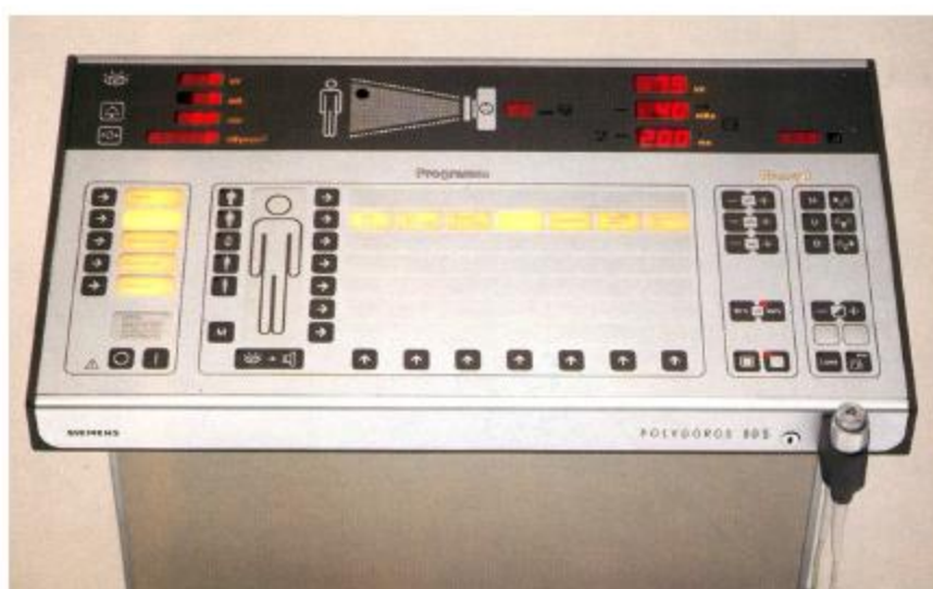
Slika 4. Operatorska konzola rendgenskog uređaja. (izvor: skripta Radiologijska aparatura prof.dr.Josip Mašković i prof.dr.Stipan Janković, Mostar 2003.g.)
