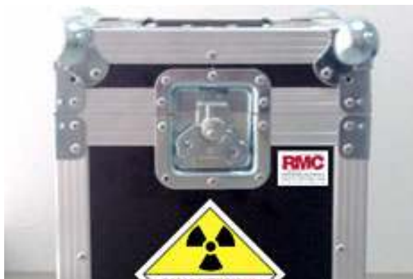
Slika 8. Transportni spremnik za radiofarmak.
