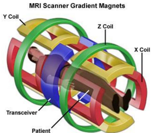
**Slika 29.** Gradijentne zavojnice
