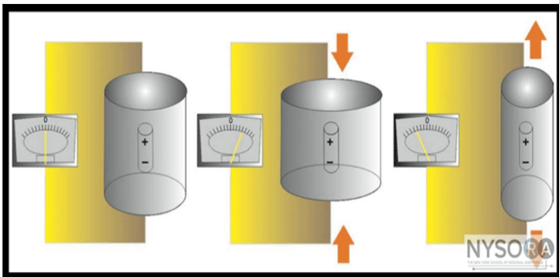
**Slika 4.** Shematski prikaz piezoelektričnog efekta
