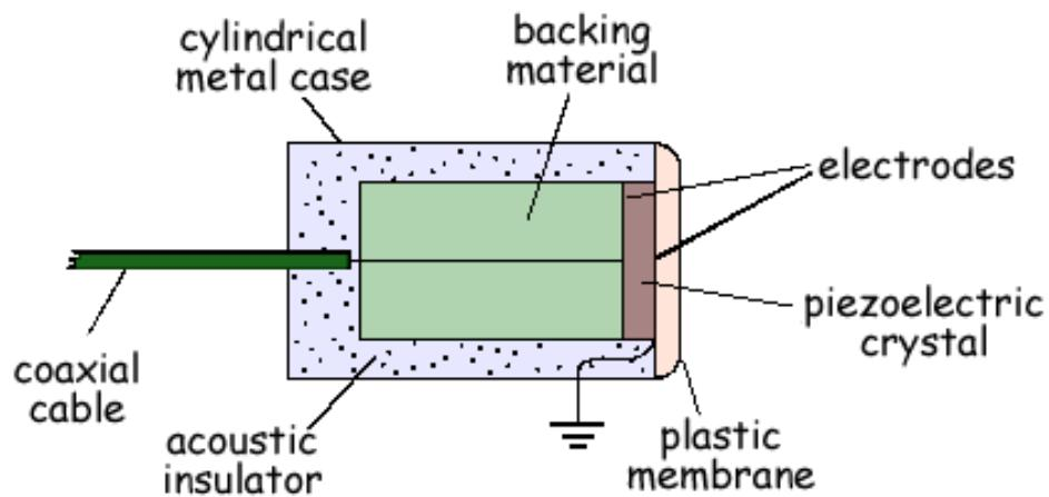
**Slika 5.** Shematski prikaz ultrazvučne sonde
