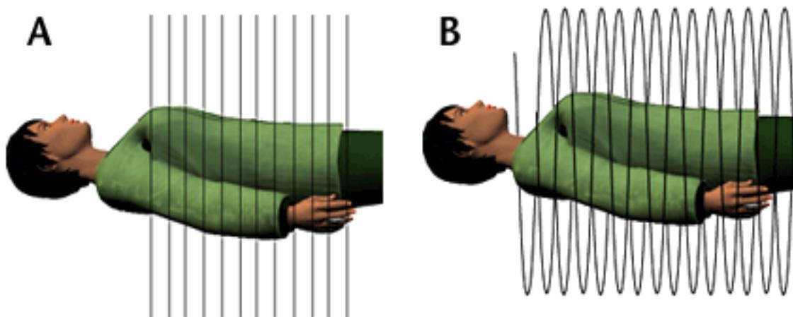
**Slika 24.** Shematski prikaz načina rada konvencionalnog (A) i spiralnog (B) CT-a
