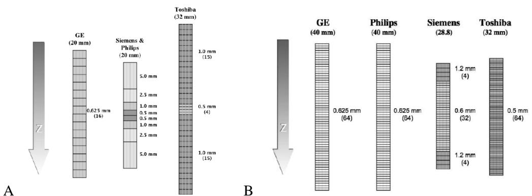
*Slika 8.* Različite veličine detektora kod uređaja različitih proizvođača. (A) Upotrebom različitih veličina redova detektora možemo dobiti različite debljine snimanog sloja. Za potrebu snimanja tanjih slojeva koriste se samo centralni detektorski elementi. (B) Primjer detektora različitih proizvođača za 64-slojno CT snimanje. [7]
