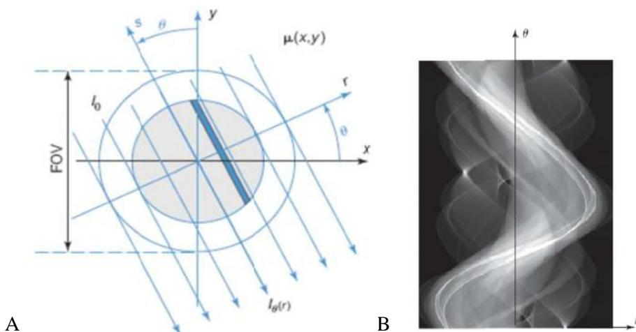
**Slika 10.** Ilustracija Radonove transformacije. (A) Koordinatni sustav  $(x, y)$  paralelan u odnosu na snimani objekt te koordinatni sustav  $(r, s)$  paralelan u odnosu na detektor zračenja. Sustav  $(x, y)$  prikazuje raspodjelu linearnih koeficijenata slabljenja  $\mu(x, y)$ , a oni koji su izvan kružnice FOV-a (field of view) jednaki su nuli. Snop zračenja, intenziteta  $I_0$ , upada pod kutom  $\theta$  u odnosu na os  $y$ . (B) Slika sinograma. [9]
