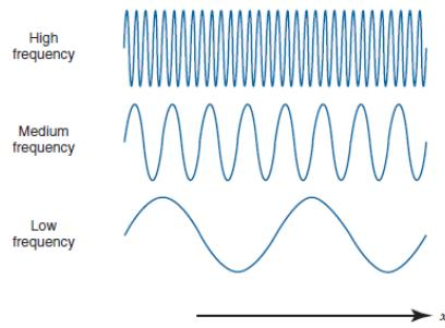
**Slika 15.** Ilustracija prostornih frekvencija sinusoidnom funkcijom. Brze oscilacije predstavljaju visoke frekvencije i spore oscilacije niske. Ako prepostavimo da  $f(x)$  predstavlja profil slike, tada bi niske frekvencije predstavljale grube strukture, a visoke fine detalje. [11]
