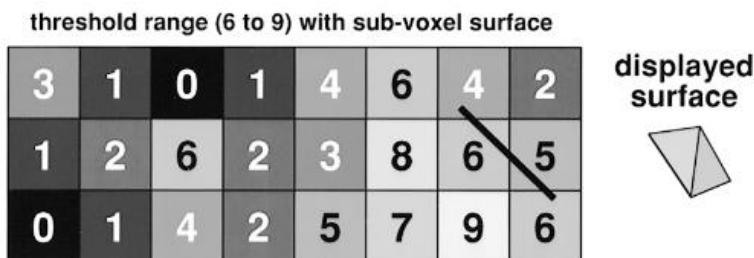
**Slika 35.** Ilustracija prikazuje princip rada SSD tehnike. Dvodimenzionalni prikaz vrijednosti voksla. Koristi se algoritam za određivanje površine unutar skupa podataka na kraju regije voksla s intenzitetom od 6 do 9. Standardne računalne grafičke tehnike se tada koriste za generiranje površine koja predstavlja definiranu regiju vrijednosti voksla. [12]
