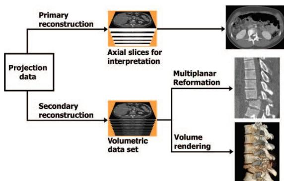
**Slika 4.** Shematski prikaz rekonstrukcije dviju odvojenih skupina podataka iz sirovih. Prva skupina se odnosi na podatke za primarne aksijalne interpretacije, dok drugoj skupini pripadaju volumetrijski podaci za MPR i 3D reformacije. [5]
