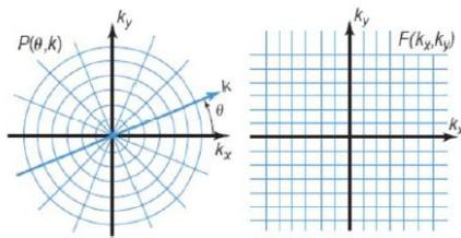
**Slika 17.** Ilustracija prikazuje prevodenje funkcije  $P(k, \theta)$  iz polarnog koordinatnog sustava u pravokutni rezultirajući Fourierovom transformacijom  $F(k_x, k_y)$ . [9]
