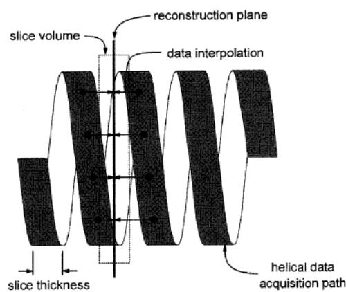
**Slika 11.** Proces rada interpolacije. Tijekom spiralnog CT skeniranja, akvizicija podataka se vrši iz spiralne putanje izvora. Prije rekonstrukcije, spiralni podaci su interpolirani u aksijalne slojeve područja od interesa. [10]
