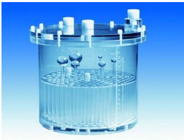
Slika 9. Jaszczak-ov SPECT fantom
