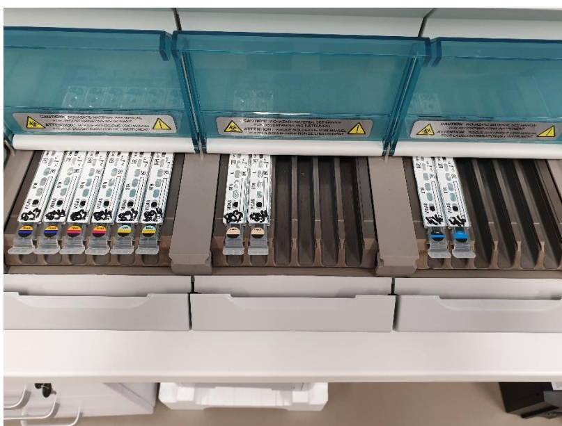
Slika 36. Postupak stavljanja kadica sa serumima u analizator
