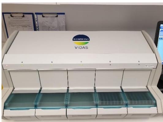
Slika 29. Vidas 30 imunokemijski analizator
