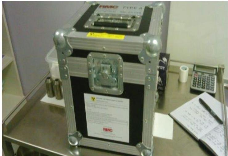
Slika 6. Olovni spremnik u kojoj se prenosi FDG.
