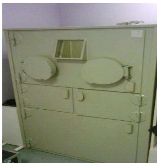
Slika 8. Uređaj za automatsko navlačenje FDG-a.
