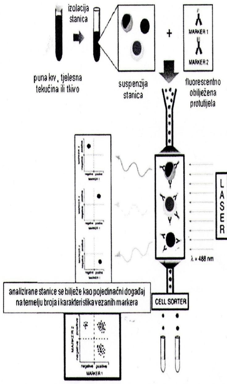
Slika 4. Princip rada protočnog citometra
