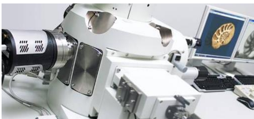
Slika 7. Skenirajući elektronski mikroskop s mikro - CT-om
