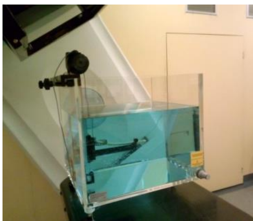
Slika 15. Prikaz mjerenja kutne ovisnosti poluvodičkog detektora u malom vodenom fantomu.
