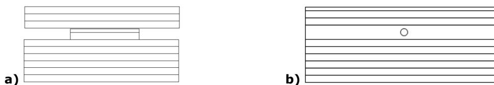
Slika 7. a) Čvrsti fantom za TLD, b) Farmer komorice u čvrstom fantomu
