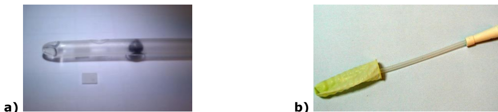
Slika 9. a) LTD izvan i unutar katetera te položaj olovne kuglice, b) kateter pripremljen za mjerenje
