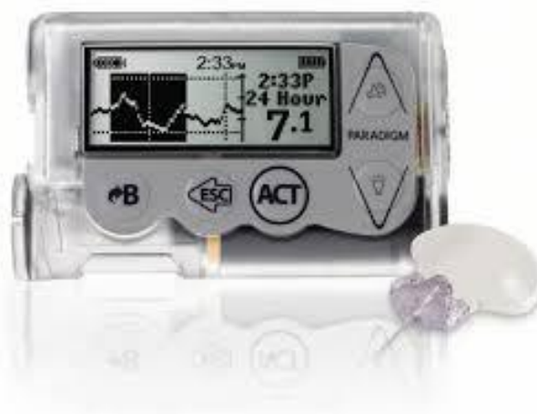
Slika 10. Inzulinska pumpa (Izvor: https://mediligo.hr/inzulinska-pumpa/ )
