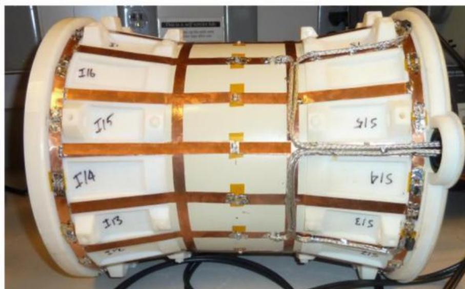
Slika 20. Dvostruko podešena  $^{1}\text{H}/^{23}\text{Na}$  „bird cage“ zavojnica (preuzeto s:
