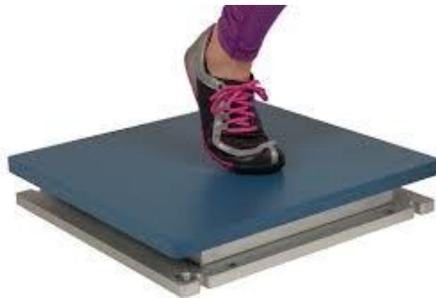
**Slika 10.** *Force plate*-ploče koje mijere silu otpora podlage
