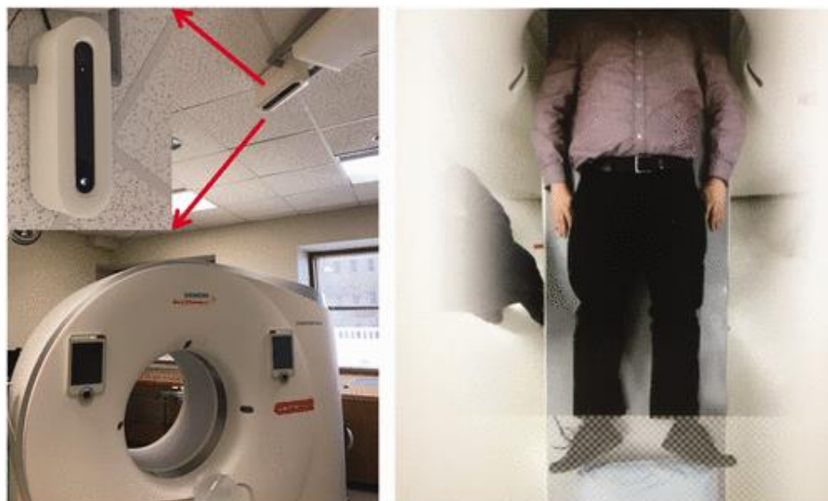
Slika 7. Trodimenzionalna kamera i njezin položaj iznad pacijentovog stola (lijevo). Optička slika i trodimenzionalna mapa dubine pacijenta dobivena pomoću kamere iznad glave (desno).
