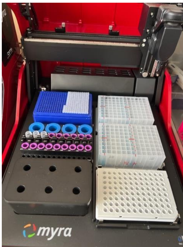
Slika 15 Robot za rukovanje tekućinom, myra bms (Nastavni zavod za javno zdravstvo SDŽ, 2022.)
