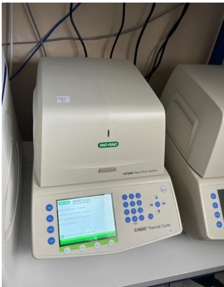
Slika 16 Uređaj BIO-RAD CFX96 ( Nastavni zavod za javno zdravstvo SDŽ, 2022.)
