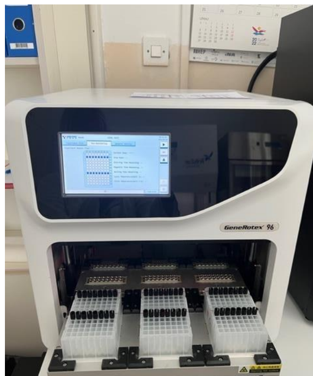
Slika 12 GeneRotex 96 automatizirani izolator nukleinskih kiselina (Nastavni zavod za javno zdravstvo SDŽ, 2022.)
