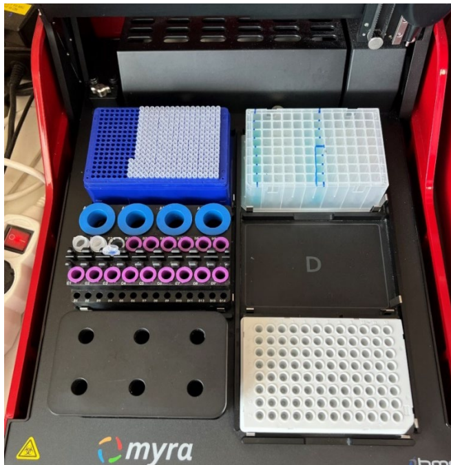
Slika 28. Myra uređaj za automatsko pipetiranje
