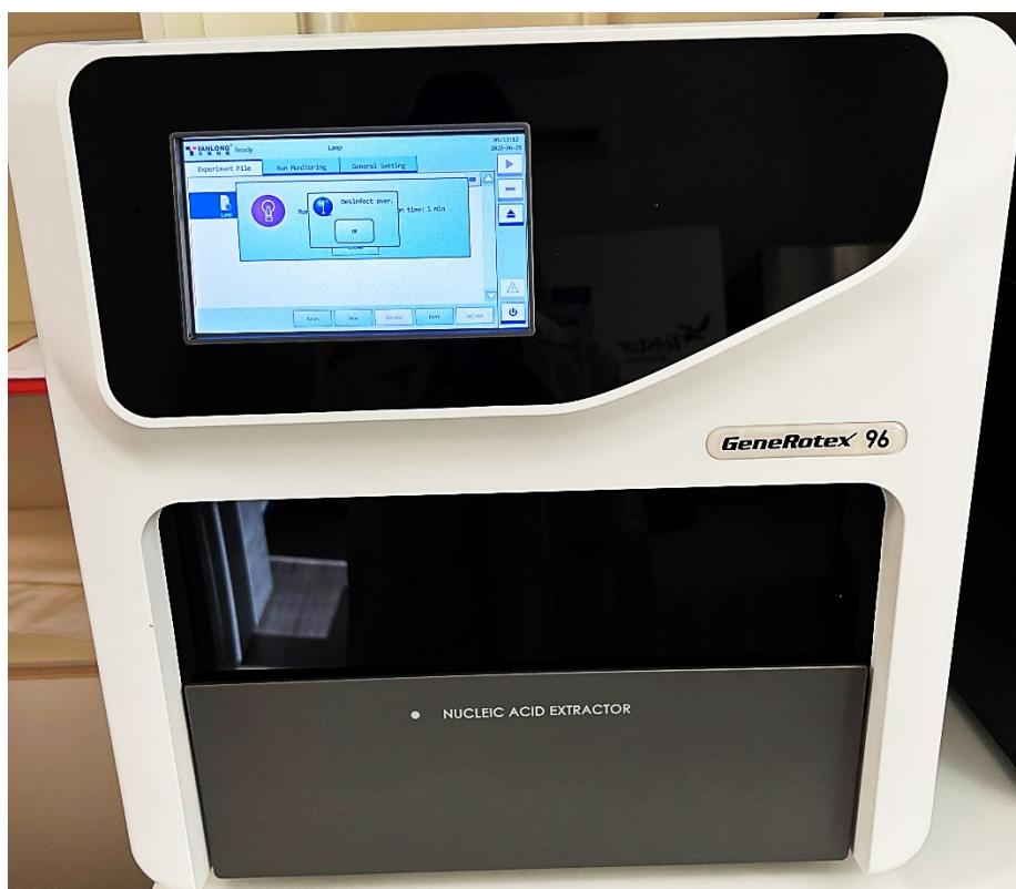
**Slika 21.** Automatski ekstraktor nukleinske kiseline (GeneRotex 96)
