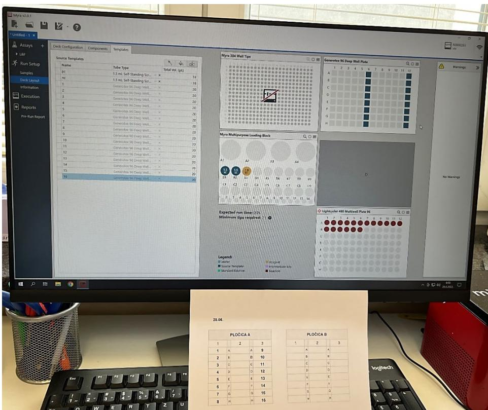
**Slika 30.** Programiranje uređaja Myra za automatsko pipetiranje
