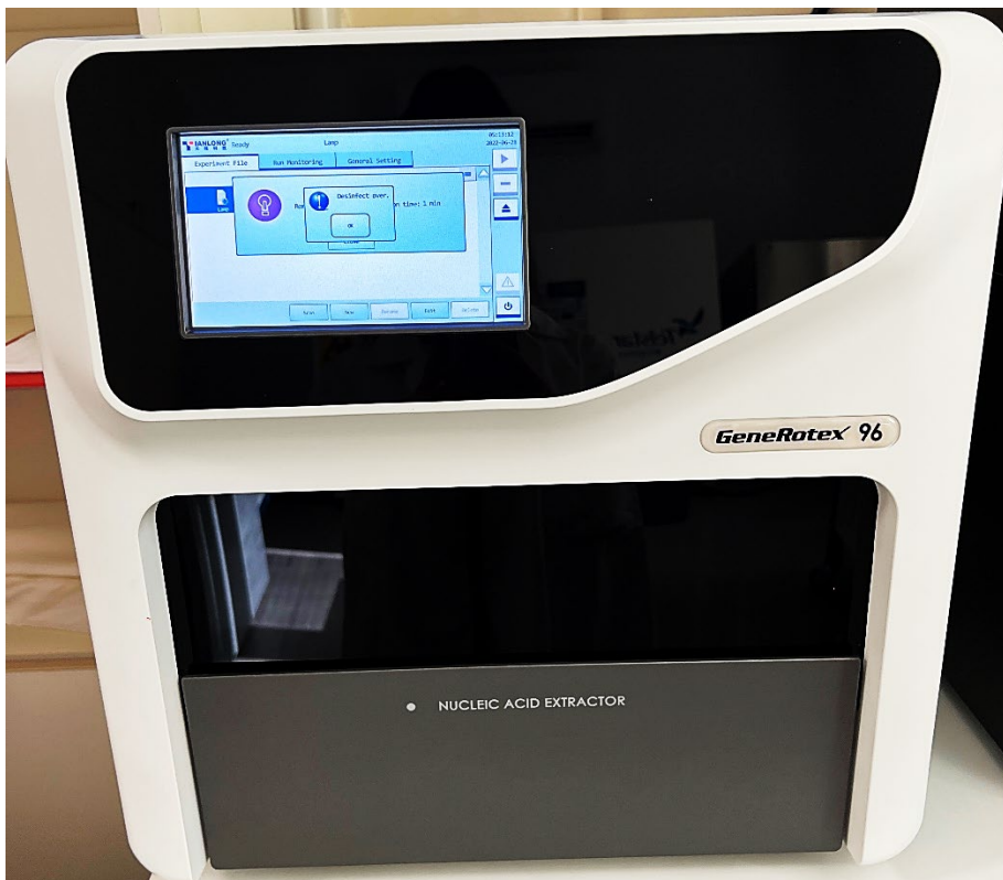
Slika 21. Automatski ekstraktor nukleinske kiseline (GeneRotex 96)
