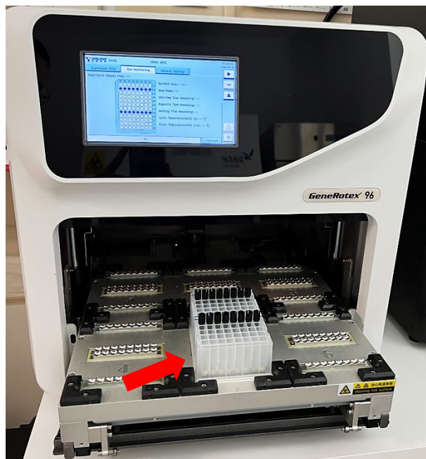
Slika 22. Nastavci za pomicanje magnetskih kuglica adsorbiranih s NK
