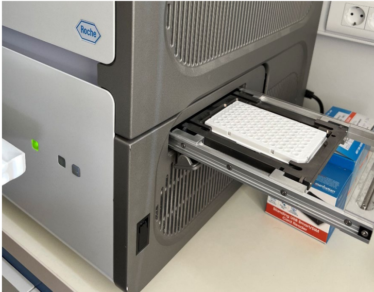
Slika 32. Umetanje mikrotitarske pločice u Cobas z480 analizator
