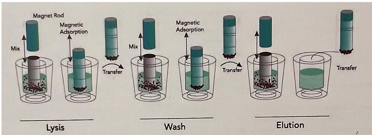
**Slika 23.** Shema rada automatiziranog ekstraktora nukleinskih kiselina
