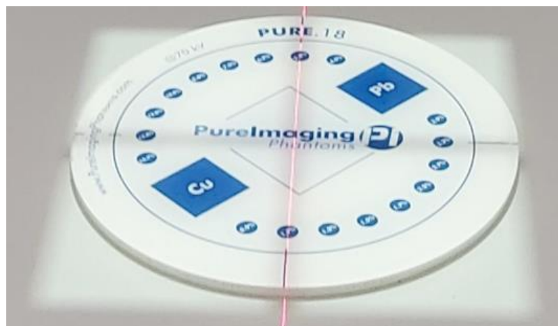
Slika 35 Otvaranje svjetlosnog polja na veličinu fantoma
