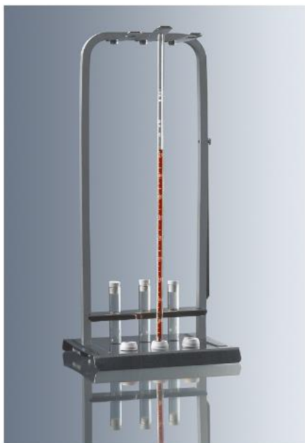
Slika 4. Westergrenova cijev na stalku
