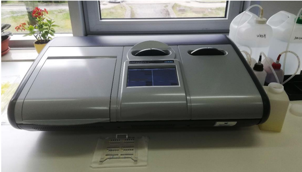
Slika 12. Analizator Hydrasis 2 Scan Focusing proizvođača Sebia.
