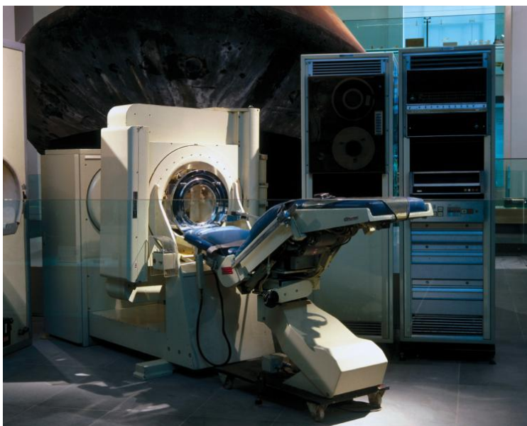
Slika 6. Povijesni EMI skener
