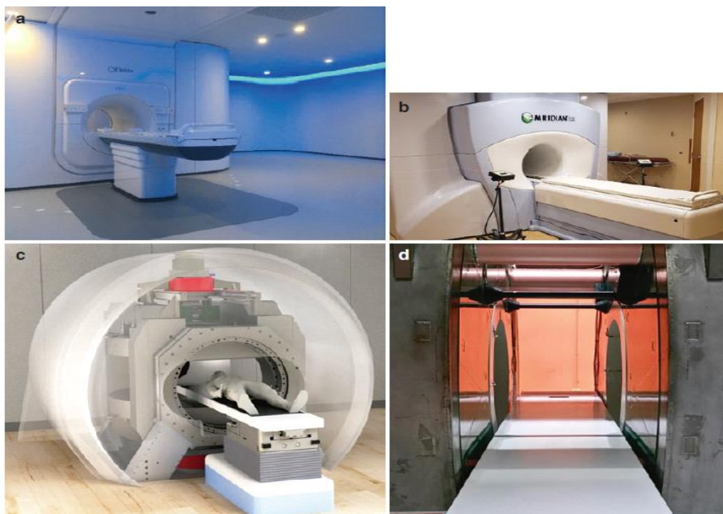
Slika 16. Slike postojećih sustava - (a) Elekta Unity, (b) ViewRay MRdian , (c) MagnetTx Aurora i (d) Australski MR-Linearni akcelerator
