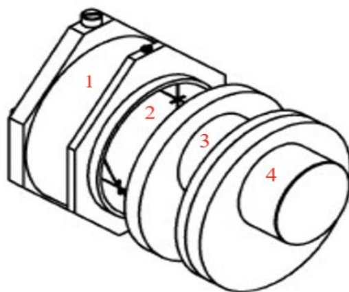
Slika 4. Fantom kontrole kvalitete za CT uređaj
