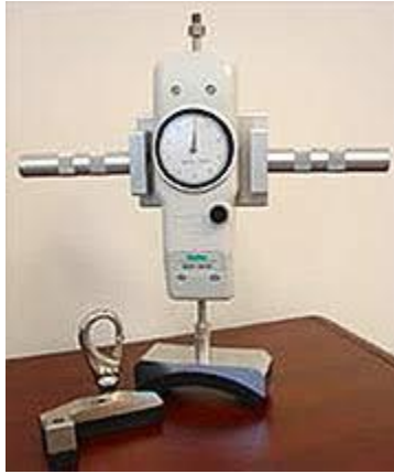
Slika 3. Prikaz mehaničkog dinamometra za mjerenje snage mišića Izvor: http://www.nexgenergo.com/medical/ametekchatmse100.html
