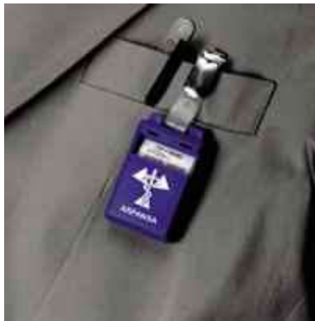
Slika 15. Prikaz dozimetra koji detektira ionizirajuće zračenje te je sastavni dio radnog odijela radiološkog tehnologa
