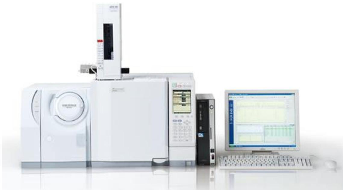
**Slika 3.** Plinski kromatograf sa spektrometrom masa; Shimadzu GCMS-QP2010
