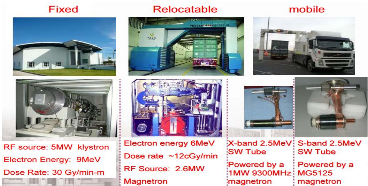
Slika 31. Sistemi inspekcije tereta i njihovi linearni sustavi
