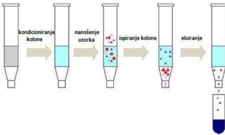
Slika 1. Shema ekstrakcije čvrstom fazom (engl. *solid phase extraction*, SPE)
