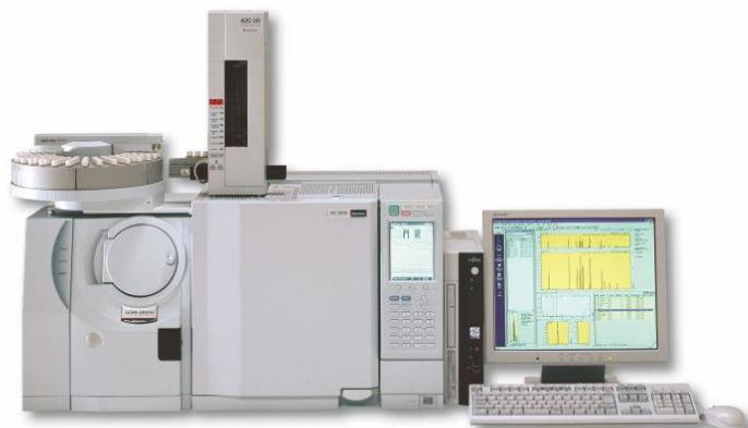
Slika 2. GC/MS plinski kromatograf sa spektrometrom masa proizvođača Shimadzu
