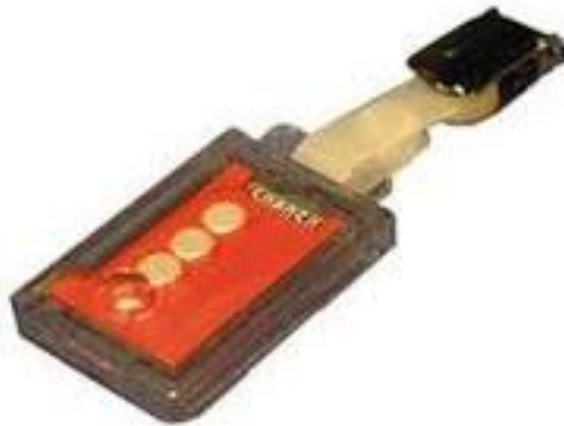
Slika 5. Film dozimetar – najčešća vrsta dozimetra u dijagnostičkoj radiologiji
