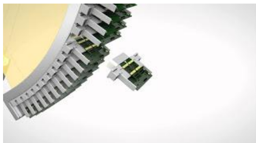
Slika 7. Matrični detektorski sustav
