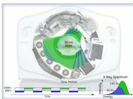
Slika 4. Presjek kroz kućište CT uređaja
