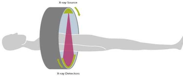
Slika 2. Princip rada kompjutorizirane tomografije – sinkronizirano okretanje izvora x-zraka i detektora oko pacijenta
