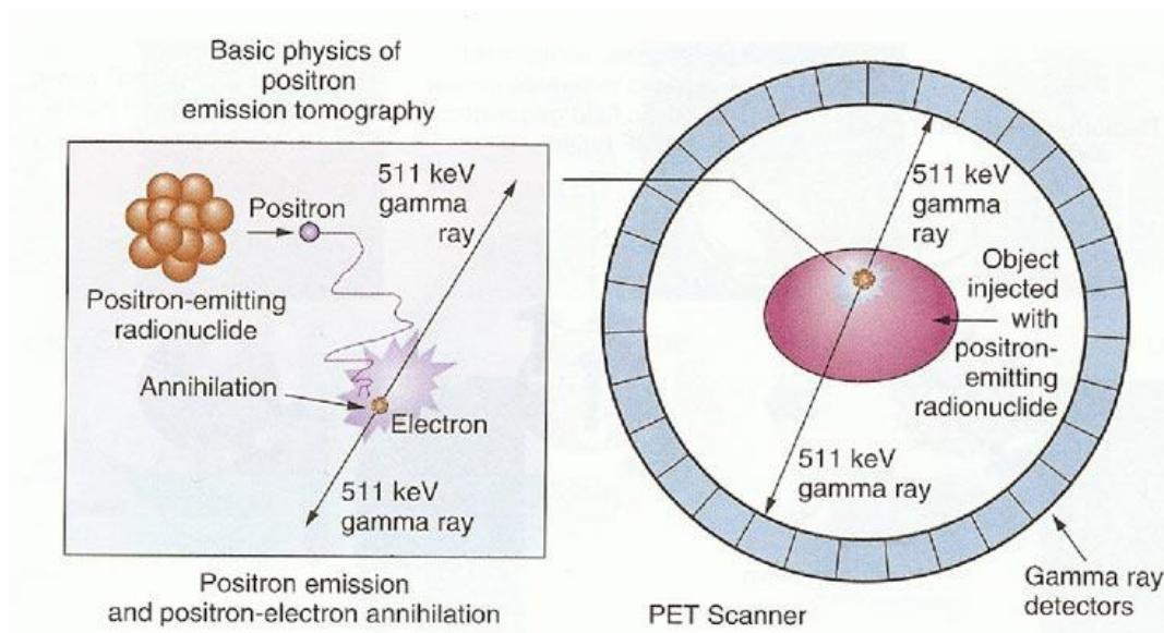
Slika 1. Osnovi princip rada pozitronske emisijske tomografije
