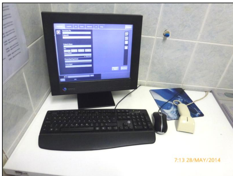
Slika 7. Računalo za naknadnu obradu slika (engl. post processing) koja je snimljena na fosfornoj ploči
